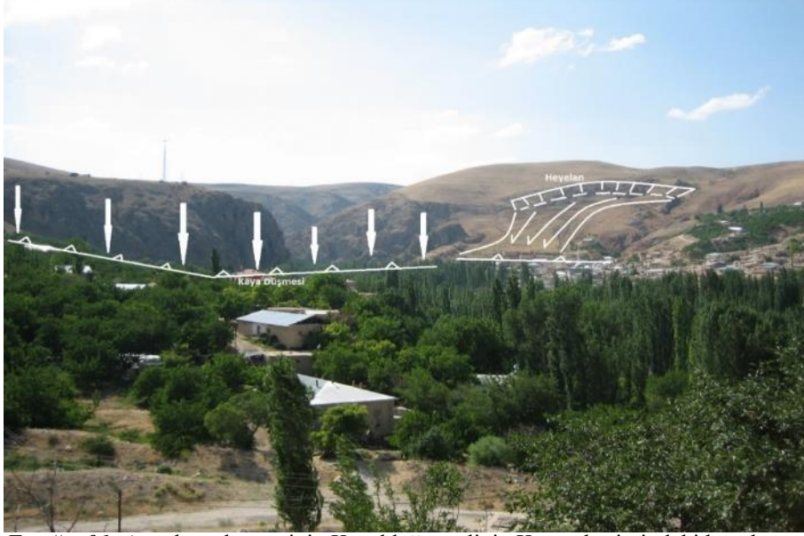
Fotoğraf 1: Ayvalı yerleşmesinin Kurulduğu vadinin Kuzey kesimindeki heyelan ve kaya düşmesi olayları konutlarda ve Tarımsal alanlarda ciddi oranda tahribat oluşturmaktadır.
